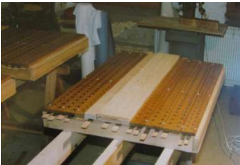
Les sommiers recevant les tuyaux. Chaque passage d'air, calibré, pour chacune des notes de chaque jeu.
